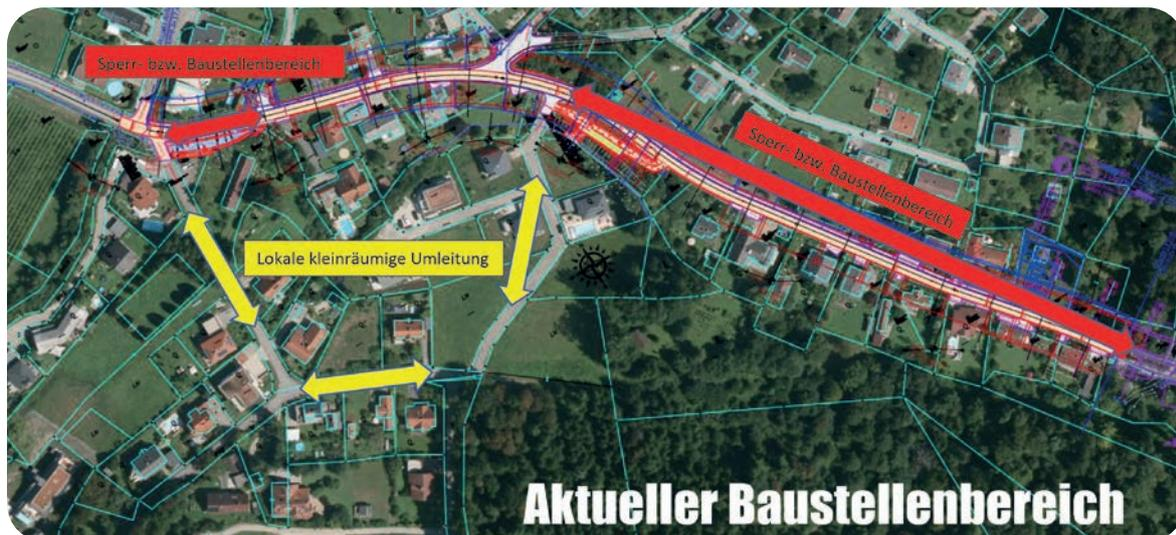
Die Straßensanierung Forststraße hat bereits begonnen. Im Zuge dessen wird die Wolfgrabenbrücke, ein Rückhaltebecken und ein Gehsteig hergestellt, sowie die technische Infrastruktur (Wasser, Strom, Post, Internet etc.) ausgebaut und erneuert.
